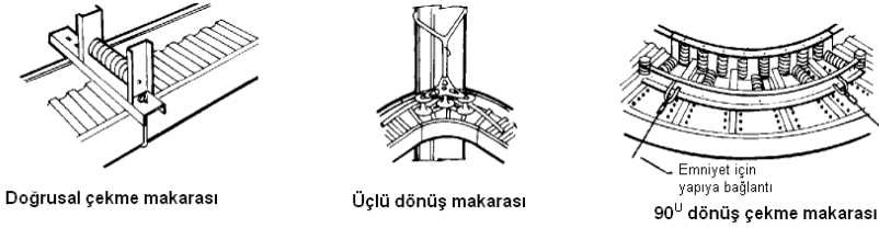
Şekil 6.141. Kablo çekme makaraları
